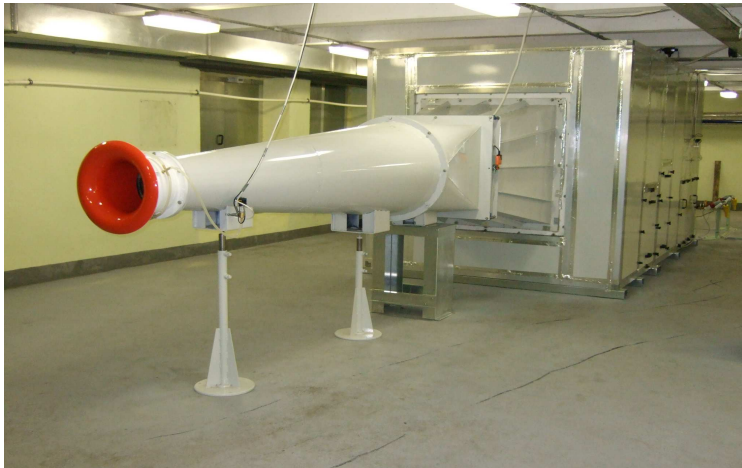
Стенд используется для испытаний радиальных и осевых вентиляторов и вентиляционных элементов с 2009 года.
