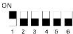
Настройка переключателя DIP 2-трубная система, регулирование 0..10 В
