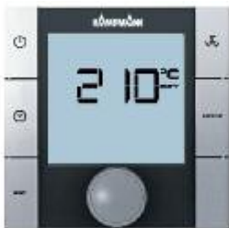
Параметр P36 = 0 «абсолютная» настройка заданной температуры
